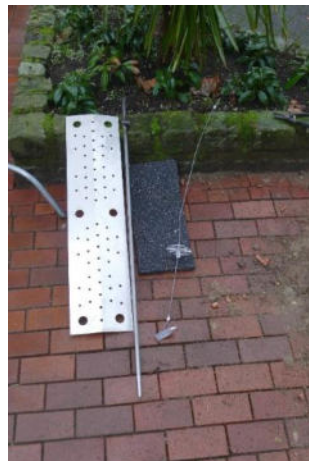
Abb. 17 – 19. Grundausrüstung zum fachgerechten Einbau der Wurzelschutzbleche und -gitter (Bohrhammer, Eintriebsstange, Arretierhaken, Spannzange, Flex, Erdanker, Schutzmatten, Bleche oder Gitter).
